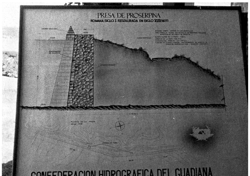
Bild 111 Querschnitt der römischen Staumauer Proserpina aus dem ersten nachchristlichen Jahrhundert. Der 3,5 Mio m 3 fassende Speichersee diente der Wasserversorgung der bekannten römischen Stadt Augusta Emerita — heute Mérida.
