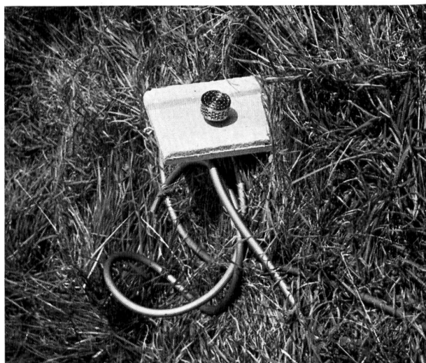
Bild 7 Schwimmer von unten; sichtbar ist der Messing-Filterkorb.
