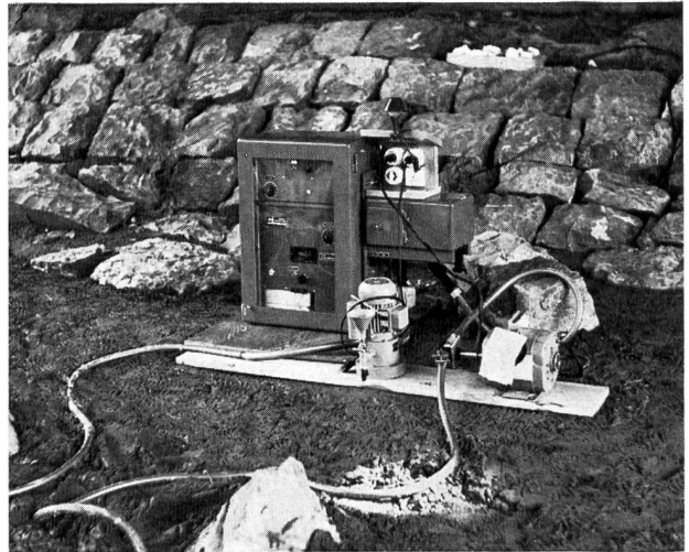
Bild 5 Sigris-Trübungsphotometer mit automatischer Registrierung und Förderpumpe.
