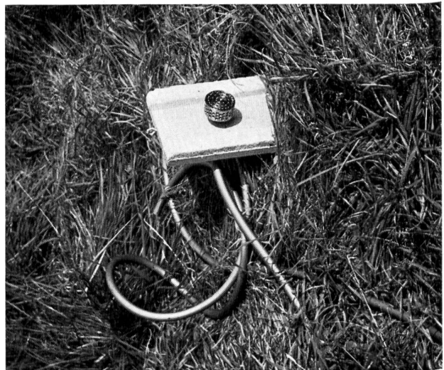
Bild 7 Schwimmer von unten; sichtbar ist der Messing-Filterkorb.
