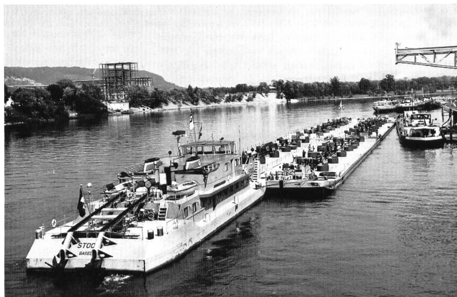
Bild 18 Beispiel der im letzten Jahrzehnt stark aufgekommen und für die Zukunft grosse Bedeutung erlangenden Schubschiffahrt. Mit diesem Tank- Schubzug gelangen 6200 t Dieselgasöl in einem einzigen Transport bis zum Rheinhafen Au bei Basel.
