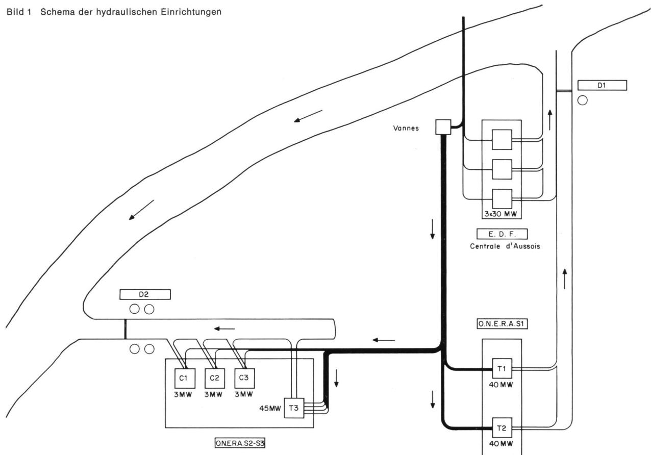
2. Der Ueberschallwindkanal S2 — MA für Dauerbetrieb wird durch eine Peltonturbine von 45 MW mit einem Durchfluss von 0...8,5 m<sup>3</sup>/s angetrieben.
