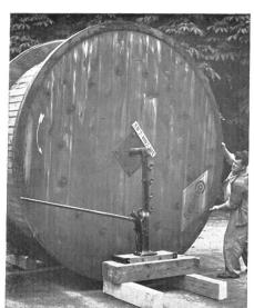
Ferner liefern wir hydraulische Kabeltrommelwinden bis 45 t für Kabel- und Eisenbahnwagen.
