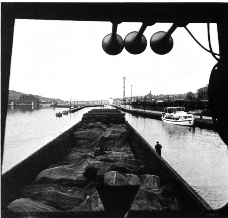
Fig. 6 (au milieu) Le convoi du «Metz» en route vers l'aval avec deux grandes barges (172x11,40 m) passe sous le pont S.N.C.F. de Thionville-Nord. On notera la timonerie escamotable en position basse (hauteur 4,60 m).
