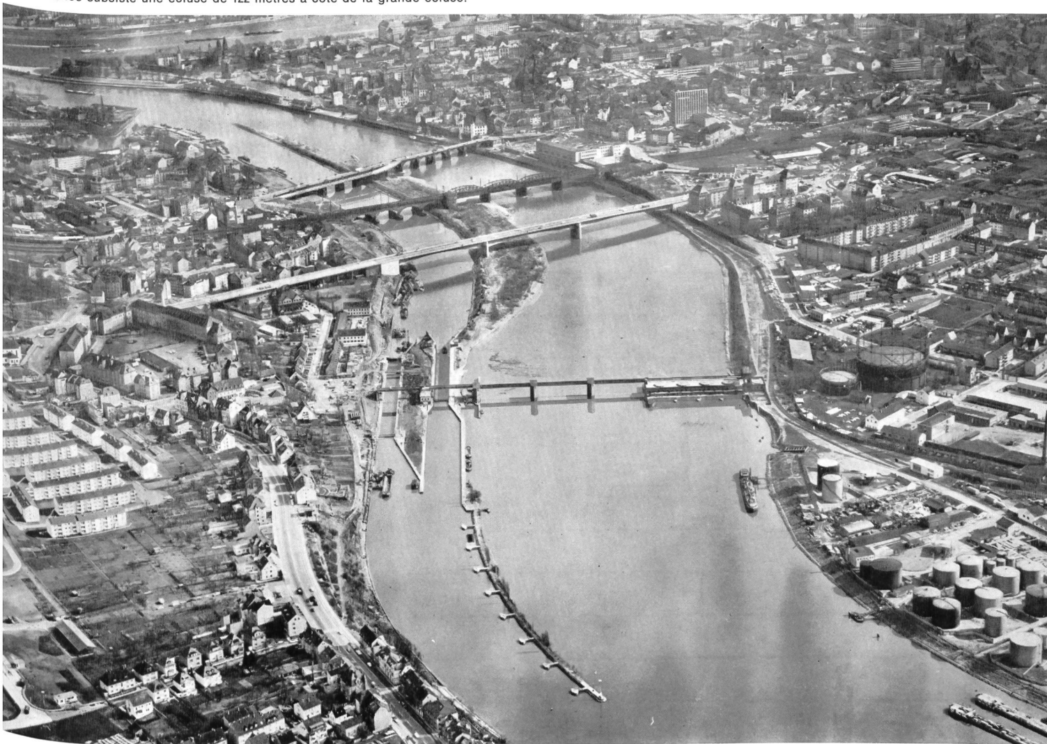
Fig. 2 La Moselle dans la traversée de Coblenz. Au fond le Rhin. Les piles du pont Balduin (le plus en aval) ont depuis été démolies. A Coblenz subsiste une écluse de 122 mètres à côté de la grande écluse.
