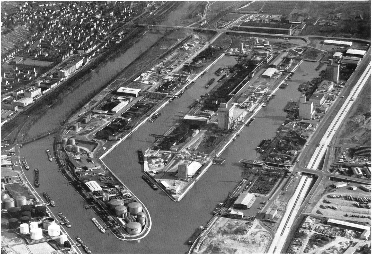
Bild 29 Teilansicht des Rheinhafens Baselstadt/Kleinhüningen mit Geleiseanschlüssen und Industrieanlagen im Weichbild der Stadt Basel. Die Umschlagsintensität (Menge pro Ladequailänge) erreicht hier Rekordwerte.
