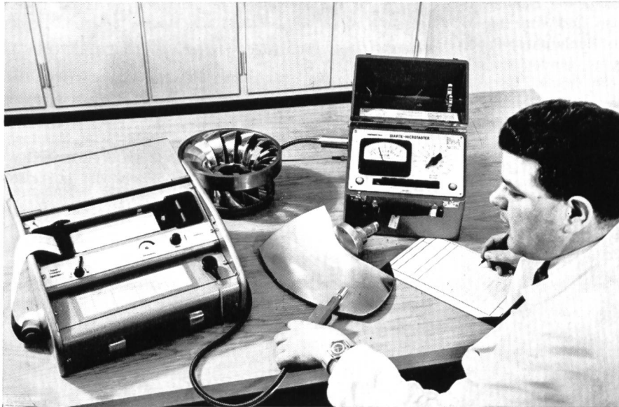
Bild 5 Messungen für die Bestimmung der Verluste von Kaplan-Turbinen bei Escher Wyss, Zürich. Kontrolle der technischen Rauigkeit einer Modell-Turbinenschaufel.
