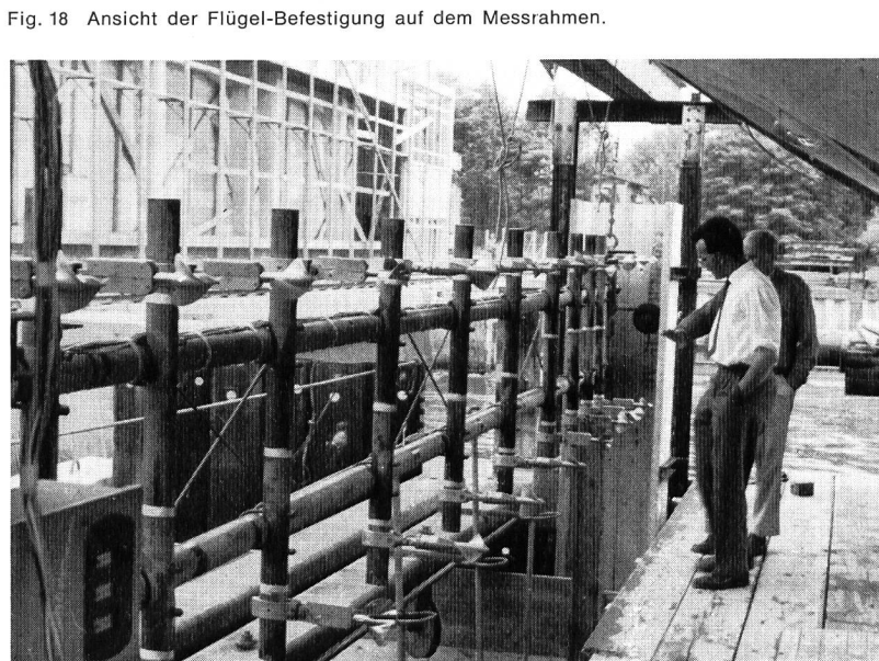
Fig. 18 Ansicht der Flügel-Befestigung auf dem Messrahmen.
