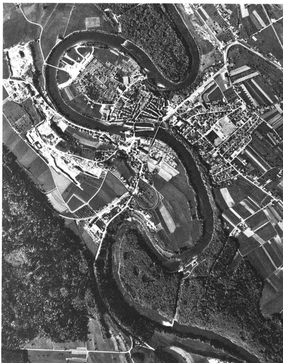
Fig. 3 Reuss bei Bremgarten. Am unteren Bildrand ist in der Reuss das Stauwehr des bestehenden Kraftwerkes Zufikon erkennbar. Unter der von dort in Richtung Bremgarten verlaufenden Waldschneise liegt der Wasserzuleitungsstollen zum ebenfalls erkennbaren Maschinenhaus. Die Staustelle des neuen Werkes (Fig. 4) ist etwas weiter flussabwärts, am Anfang der geraden Reusstrecke vorgesehen.
