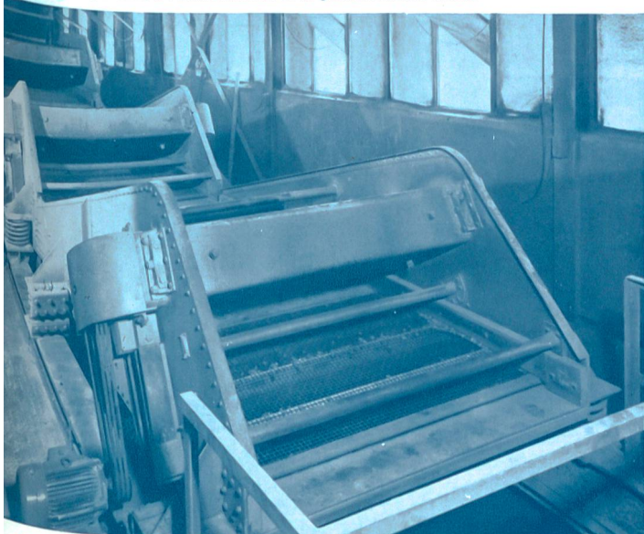
Resonanzschwingsieb Typ FA zur Absiebung von Schotter, Splitt und anderen Materialien Resonance oscillating screen type FA for screening of ballast and chippings, etc. Crible oscillant à résonance, type FA pour criblage de pierraille, gravaillages et autres matériaux
