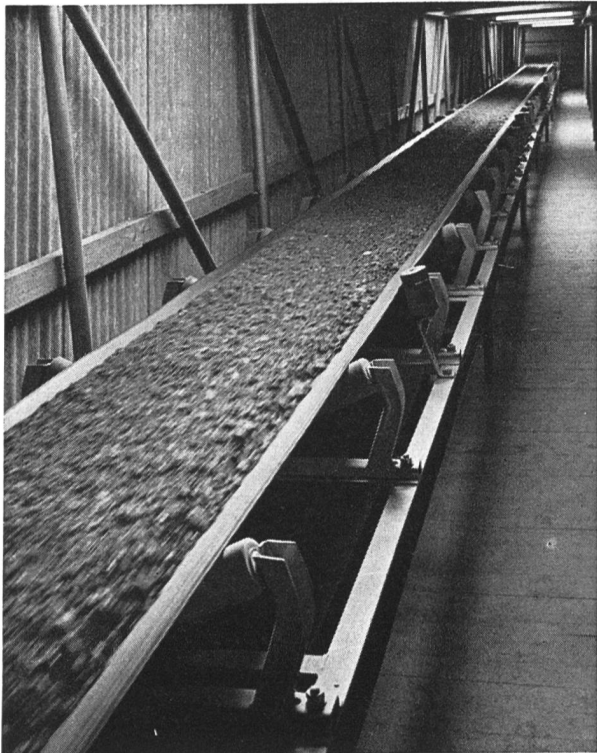
ICO-CUSHION-Transportband in einem Kieswerk
