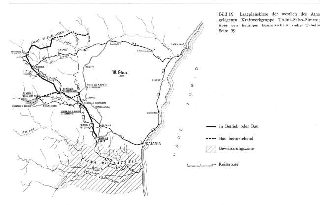
Kernobjekte dieser Wasserkraftnutzung sind die großen Stausen Ancipa mit 27,8 Mio m³ Nutzinhalt und Pozzillo mit 141 Mio m³; daß dieses hier gespeicherte Wasser für Bewässerung und Kraftnutzung Gold wert ist, leuchtet ohne weiteres ein. Die für diese Stauseen erforderlichen großen Talsperren boten neben den üblichen Problemen des Talsperrenbaues noch besonders heikle Fundationsprobleme wegen der unmittelbaren Nähe des stets in mehr oder weniger starker Eruption befindlichen Ätnas.
