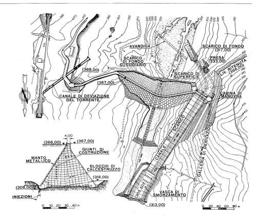
Bild 26 (oben) Lageplan und Querschnitt der Talsperre Pozzillo am Salso-Fluß westlich des Ätna. Man beachte besonders das riesige Bauwerk für die Hochwasserentlastung
