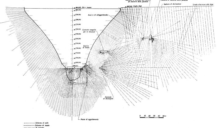
Bild 4 Bogensperre Speccheri; Dichtungsschirm im Sperrenfundament und im Fels der rechten Sperrenflanke
