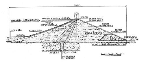
Bild 6 Querschnitt durch den Staudamm Bomba am Sangro
