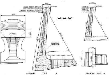
Bild 3 Pfeilerkopfmauer Casoli am Flusse Aventino, einem Zufluß zum Sangro; verschiedene Schnitte
