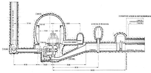
Bild 7 Kavernenzentrale Montorio, Querschnitt
