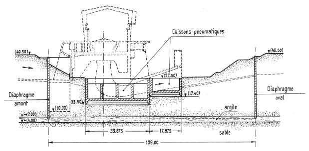
Fig. 14 Usine d'Isola Serafini; coupe des fouilles
