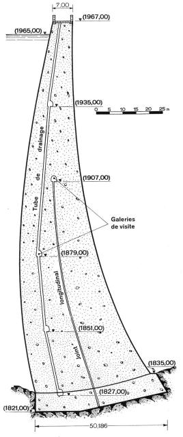
Fig. 2 Barrage de Place Moulin; section transversale
