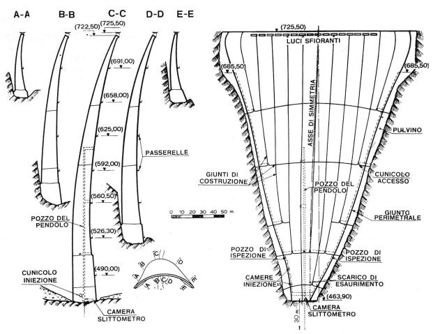
Bild 9 Bogensperre Vaiont an einem linken Zufluß des mittleren Piave; talseitige Ansicht und Querschnitte
