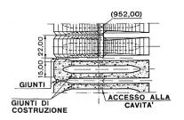
Bild 22 Typenquerschnitt und Horizontalschnitt durch die Pfeilerkopfmauer Ancipa
