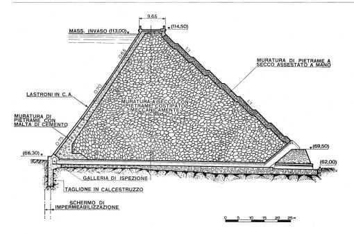
Bild 22 Steindamm Cuga, Querschnitt
