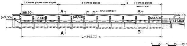
Fig. 13 Usine d'Isola Serafini; vue d'amont et sections transversales
