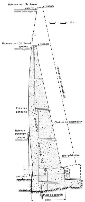
Fig. 8 Barrage de Cancano II; section transversale
