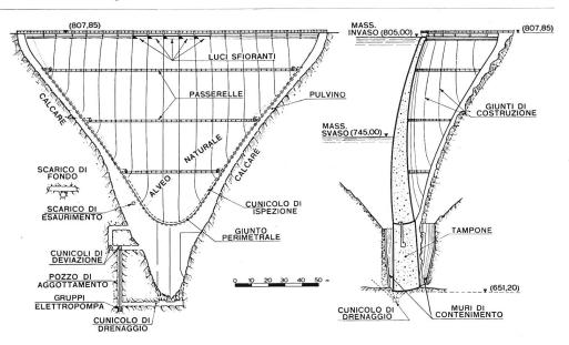
Bild 3 Bogensperre Speccheri am Torrente Leno di Vallarsa, einem linken Seitenfluß der Etsch; talseitige Ansicht und Querschnitt
