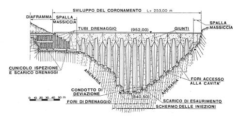
Bild 21 Längsschnitt der Pfeilerkopfmauer Ancipa (diga a gravità alleggerita) am Torrente Troina; mit 111,5 m Höhe handelt es sich um die höchste Talsperre dieser Bauart
