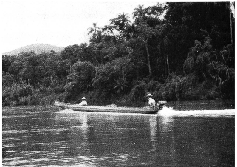
Bild 10 Einbaum mit Außenbordmotor auf dem Rio Ribeira. Die Seitenwände sind durch aufgesetzte Bretter erhöht worden. Auf solchen Booten wurden auch gewichtige Stücke, z. B. Kernbohrgeräte, transportiert.
