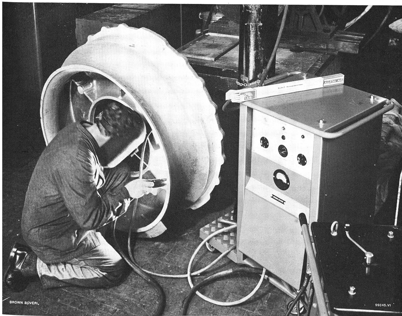
Das Brown Boveri Argon-Schweißgerät Typ WS 300 im Einsatz bei einer Reparaturschweißung an einem Aluminiumgußstück. Mit diesem Universalgerät können sämtliche Metalle geschweißt werden.
