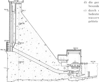
Bild 28 Querschnitt durch Gewichtsstaumauer und Zentrale Buendía
