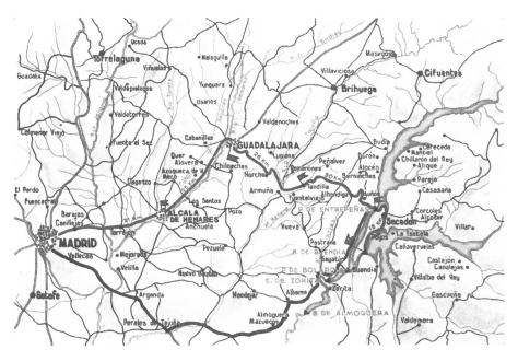
Bild 24 Routenplan von Madrid zu der Kraftwerkgruppe am oberen Tajo mit den großen Speicherseen Entrepeñas und Buendía von zusammen 2,293 Mrd m³ Nutzinhalt
