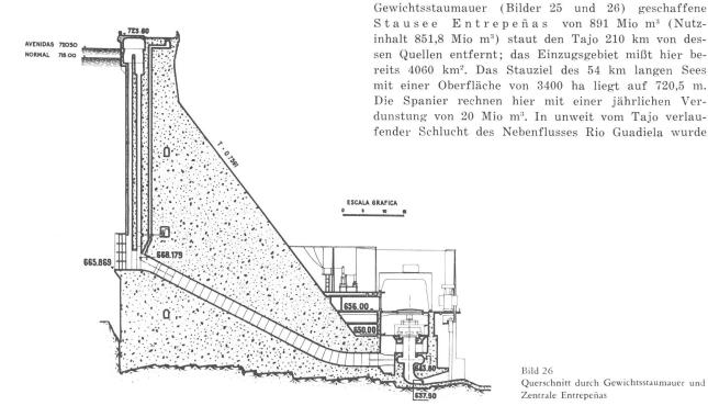
Bild 26 Querschnitt durch Gewichtsstaumauer und Zentrale Entrepeñas
