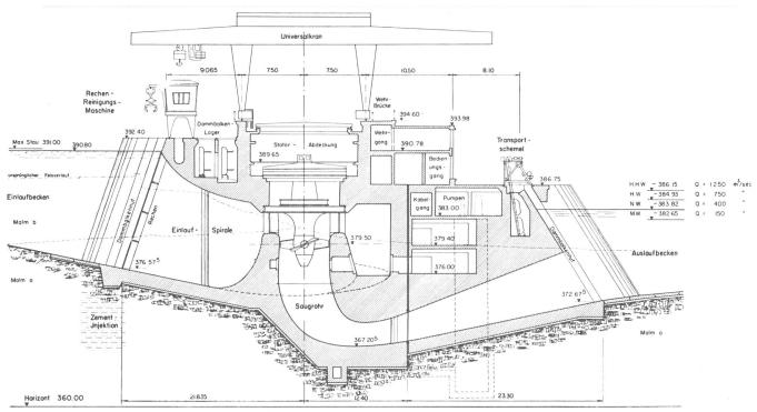
Bild 4 Querschnitt durch das Maschinenhaus; Maßstab 1:500
