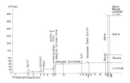
Bild 13 Mittlere Wasserführung in m³/s am 11./12. März 1959
