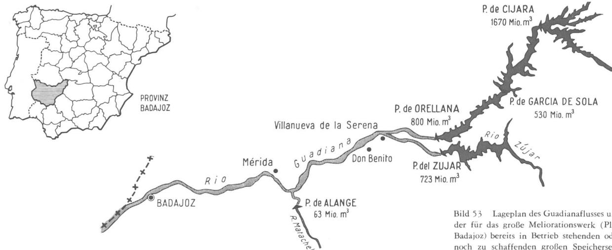
Bild 53 Lageplan des Guadianaflusses und der für das große Meliorationswerk (Plan Badajoz) bereits in Betrieb stehenden oder noch zu schaffenden großen Speicherseen
