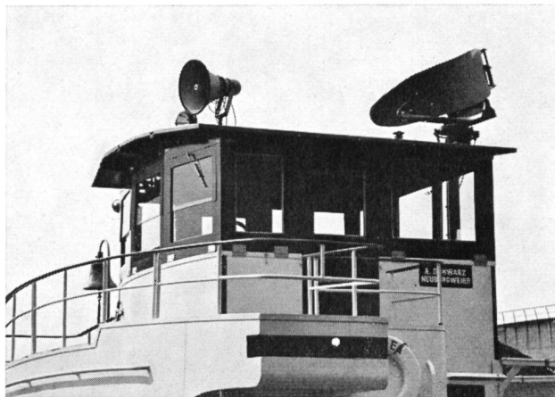
Bild 7 Flußradar Steuerhaus des Passagier- und Güterschiffes «Basilea» mit Radareinrichtung (Schweizerische Reederei AG)
