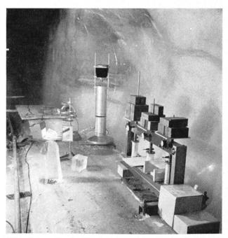
Bild 1 Laboratorium der Schweizerischen Gletscherkommission im Innern der Eiskalotte auf Jungfraujoch. Querstollen Q<sub>100</sub>, Kreisprofil. Rechts: Nachprüfung des Fließgesetzes für polykristallines Eis mit Hilfe von zylindrischen Druckproben. Die Eisproben wurden an Ort und Stelle entnommen; Temperatur —1° bis —2°.
