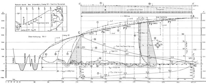
Fild 11 Vergleich zwischen dem gemessenen und berechneten Querschnitt des Inlandeises (Grönland).
