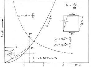
Bild 2 Fließkurve des Eises (schematisch),  $\mu$  = scheinbare Zähigkeit.
