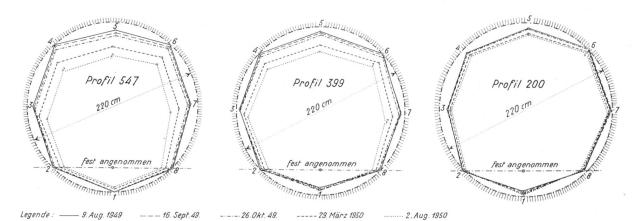
Bild 6 Verformung der Kreisprofile im Eisstollen des Zmuttgletschers. Da in der Bildebene ein nahezu hydrostatischer Spannungszustand vorherrscht, bleibt die Kreisform erhalten. Überlagerungshöhen: Profil 200, 399 und 547 = 25, 44 bzw. 43 m.
