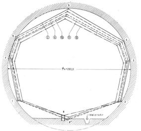
Bild 8 Verformung des Kreisprofils im Eisstellen  $Q_{100}$  der kalten Eiskalotte auf Jungfraujoch (Temperatur —1 bis —2° C).
