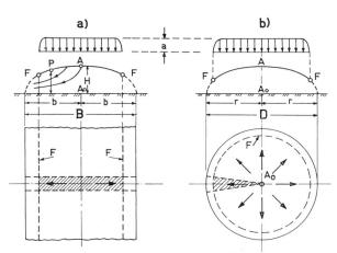
Bild 9 Schema des streifenförmigen und sphärischen Eisschildes.
