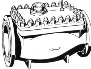
Wasserzähler mit Ferngeber für Zählung sowie Anzeige und Registrierung der momentanen Durchflussmengen
