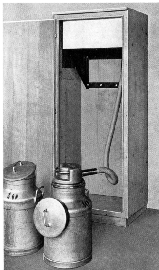
Bild 3 Der Milchkannenkühler, heute ein unentbehrliches Gerät zur Hebung der Milchqualität (Haltbarkeit)
