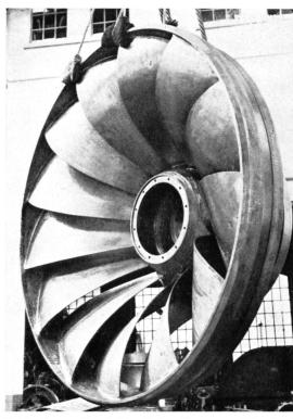
Bild 6 Extreme Francis-Schnelläuferturbine,  $n_{\rm s}=330$ , für die Anlage Neuhausen; 6520 PS, Gefälle etwa 21,5 m (1950)
