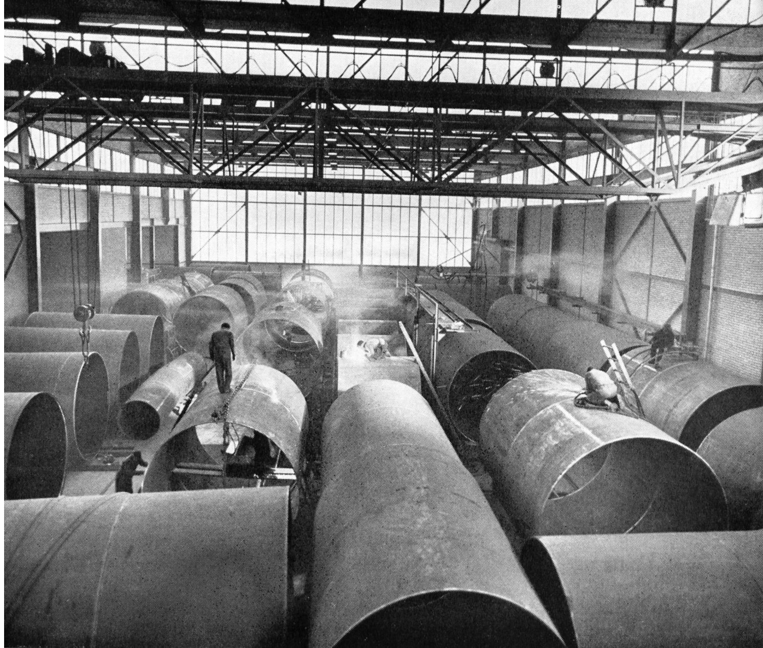
Panzerrohre in Fabrikation
