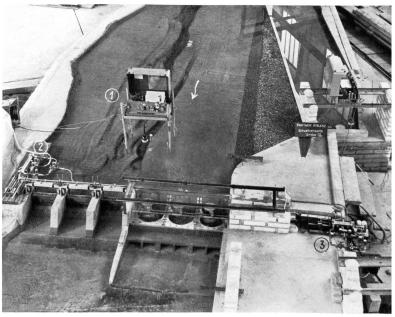
Bild 6 Kraftwerk Koblenz, Modellansicht. Maschinenhaus und Wehr vom Unterwasser aus gesehen. U. a. Prüfung der Einlaufverhältnisse zu den Turbinen. Die Photo zeigt beidseitig des Wehres und Maschinenhauses die Servosteuerungen der Schützen und der Turbinen zwecks Nachbildung von Schwallerscheinungen bei Öffnen und Schließen der Maschinen. Im Oberwasser elektronischer Limnigraph. Modellmaßstab 1:60.
