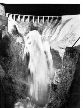
Bild 4 Kraftwerk Verbano, Staumauer Palagnedra, Hochwasserentlastung. Untersuchung der Stellung der Brückenpfeiler zwecks Konzentration des Strahles nach der Talachse. Belichtung 1/100 Sekunde. Q = 450 m³/s. Modellmaßstab 1:50
