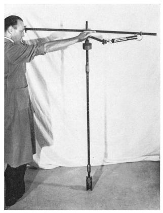
Bild 13 Drehflügelsonde. D = 50 mm, h = 70 mm
