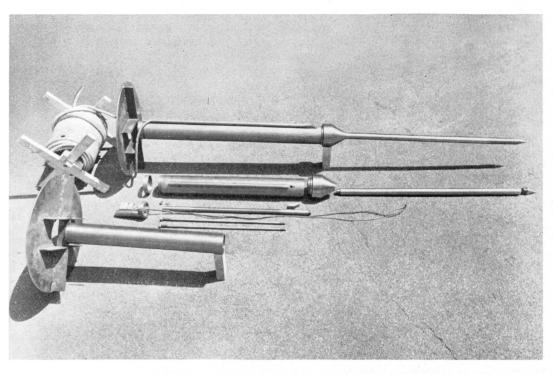
Bild 14 Elektrischer Setzungspegel
