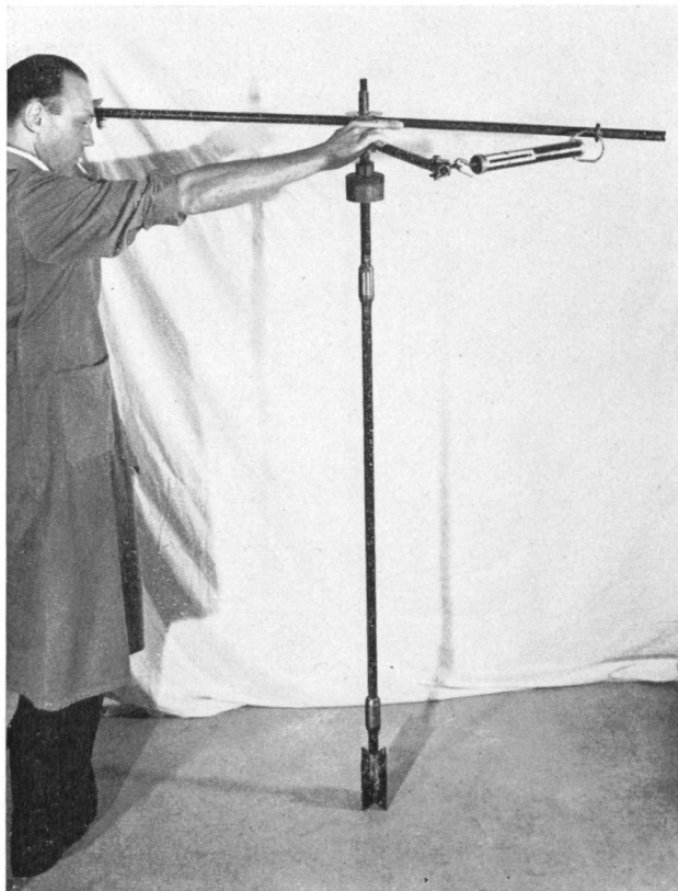
Bild 13 Drehflügelsonde. D = 50 \text{ mm} , h = 70 \text{ mm}
