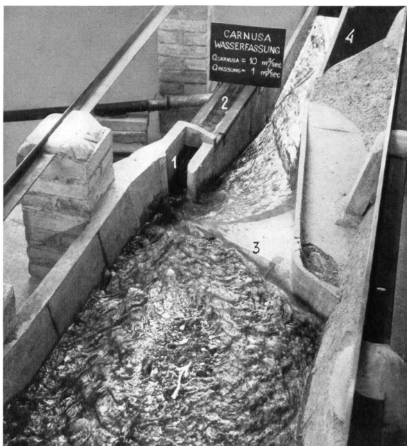
Bild 10 Kraftwerk Zervreila, Kleinfassung Carnusa. 1 Typus geschiebelose Anordnung («Umlenk-Fassung») 2 Entsander 3 Leitbühne 4 Unterwasserkanal Q_{\text{Fassung}} = 1 \text{ m}^3/\text{s} Q_{\text{Fluß}} = 10 \text{ m}^3/\text{s} Leitbühne erforderlich, weil die Fassung nicht an der Außenseite der Krümmung erstellt werden konnte. Modellmaßstab 1:25.
