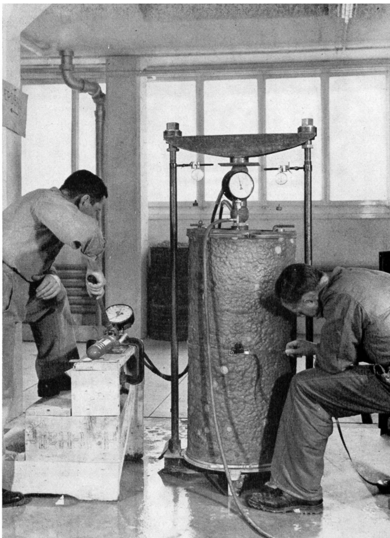
Bild 20 Probe nach der Durchführung eines Versuches im Vakuum-Triaxialgerät. F = 2000 \text{ cm}^2
