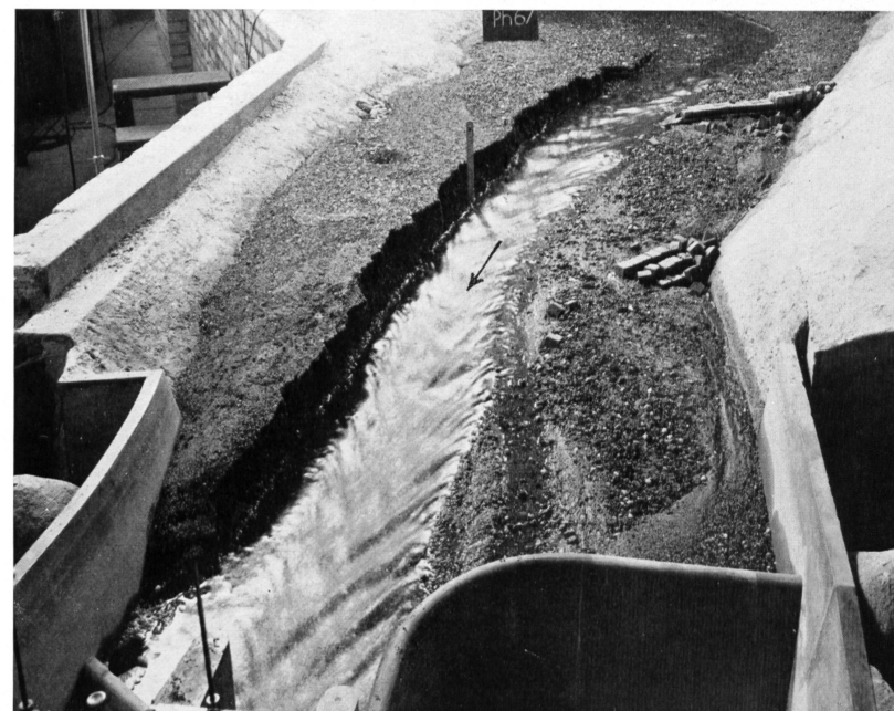
Bild 11 Wasserfassung Averser Rhein (Kraftwerkgruppe Valle di Lei — Hinterrhein). Spülversuch des verlandeten Stauraumes. Blick auf Erosionsrinne nach 15 Std. Spülung mit Q = 6 \text{ m}^3/\text{s} . Flußaufwärts zwei Leitbühnen zwecks Ablenkung gegen rechtes Ufer. Abspülung etwa 3000 m 3 . Einzugsgebiet 42,5 km 2 . HHQ \sim 170 \text{ m}^3/\text{s} . Jahreswasserfracht \sim 62 \text{ Mio m}^3 . Modellmaßstab 1:30.
