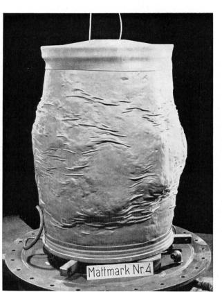
Bild 19 In eine Gummihülle eingebautes, kohäsionsloses Material für einen Erddamm vor Beginn eines Vakuum-Triaxialversuches.  $F=2000~\rm cm^2$
