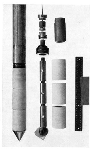
spezifischen Setzung eines Bodens und liefert einen der beiden maßgebenden Faktoren zur Setzungsberechnung eines Bauwerkes.
