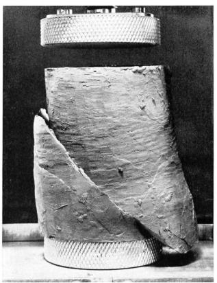
Bild 17 Siltige Tonprobe nach dem Druckversuch mit unbehinderter Seitenausdehnung im Farnellapparat. Querschnitt der Probe = 25 cm<sup>2</sup>
