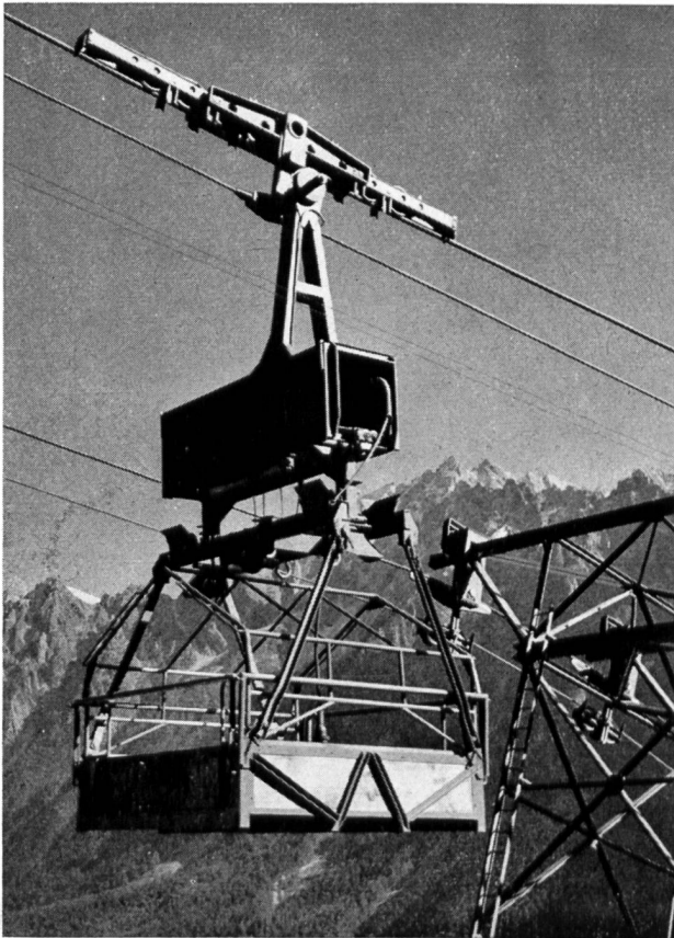
Bild 1 Baustellenseilbahn im Gebirge, häufig das einzige Transportmittel zu Stollenbauten
