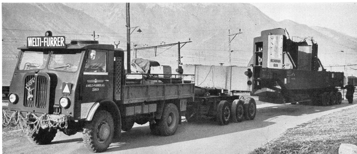
Transport einer Statorhälfte von 54 Tonnen
