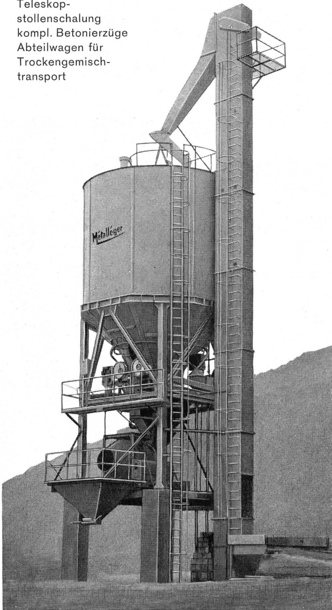
Betondosieranlage Métallegér Typ 130/40 in den Misoxer Kraftwerken
