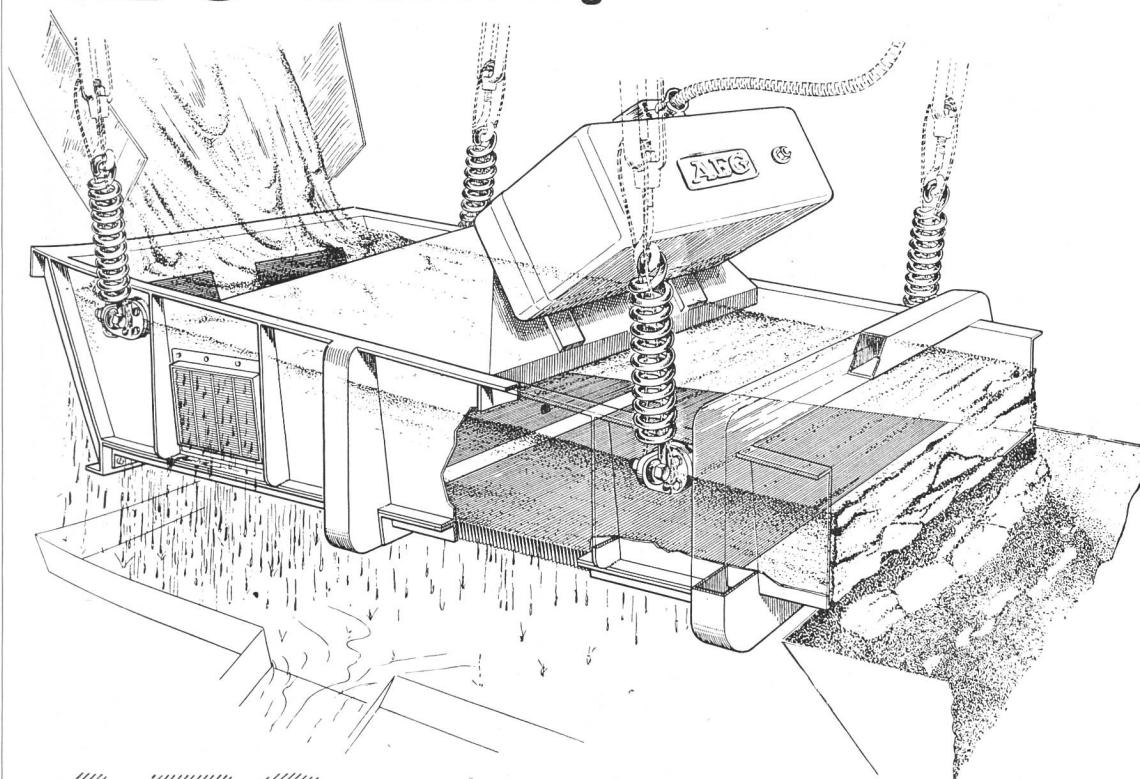
Zur Automatisierung des Betriebes auf Großbaustellen, in Kies- und Betonwerken durch motorlose, wartungs- freie u. verschleißfeste Vibrationsfördergeräte mit kontinuierlicher Steuerung der Förderleistung.
