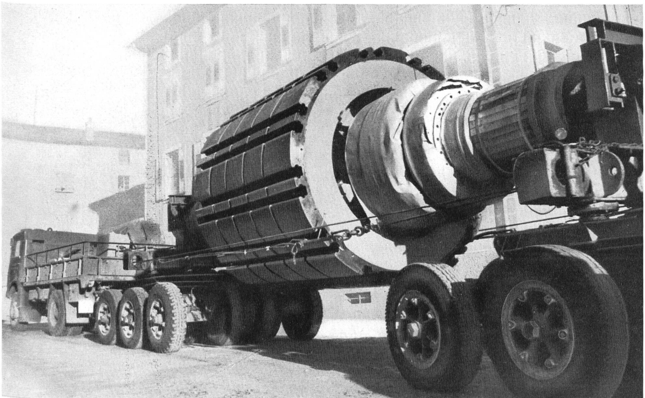
Transport eines 100-Tonnen-Rotors mit besonderer Aufhängekonstruktion
