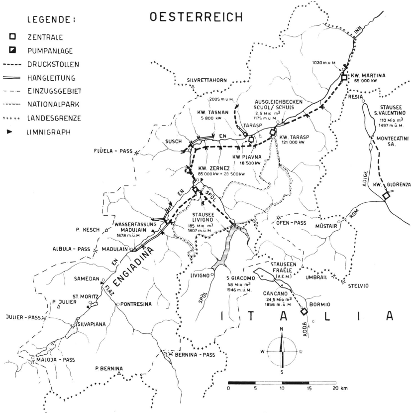
Plan 3 b Inn/Spöl-Projekt 1952 des «Konsortiums für Engadiner Kraftwerkprojekte» (KEK)
