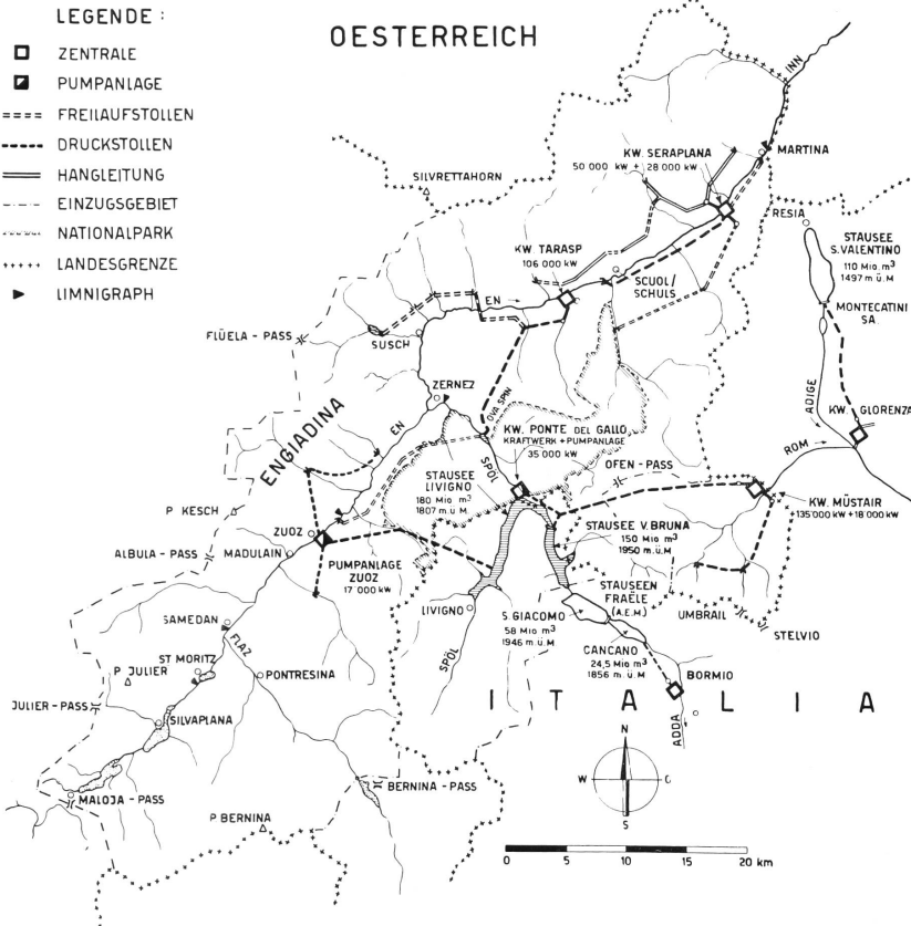
Plan 3 a Inn/Spöl-Projekt 1952 des «Konsortiums für Innkraftwerke» (KIK) mit Wasserkraftnutzung Richtung Münstertal/Etsch
