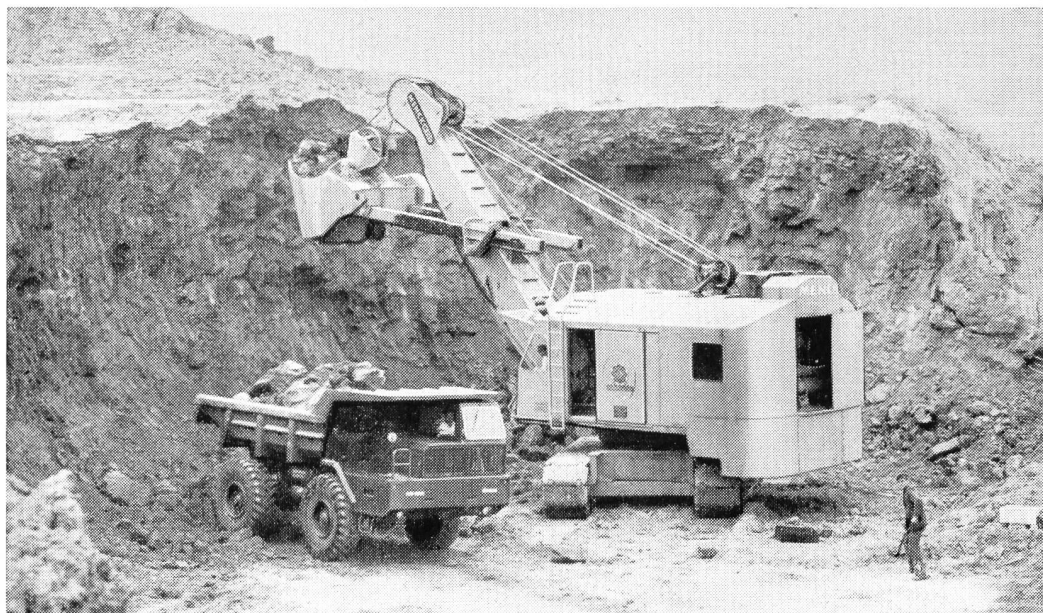
Ein 2,5 m 3 Universalbagger vom Typ MENCK M 251 bei schwerem Einsatz
