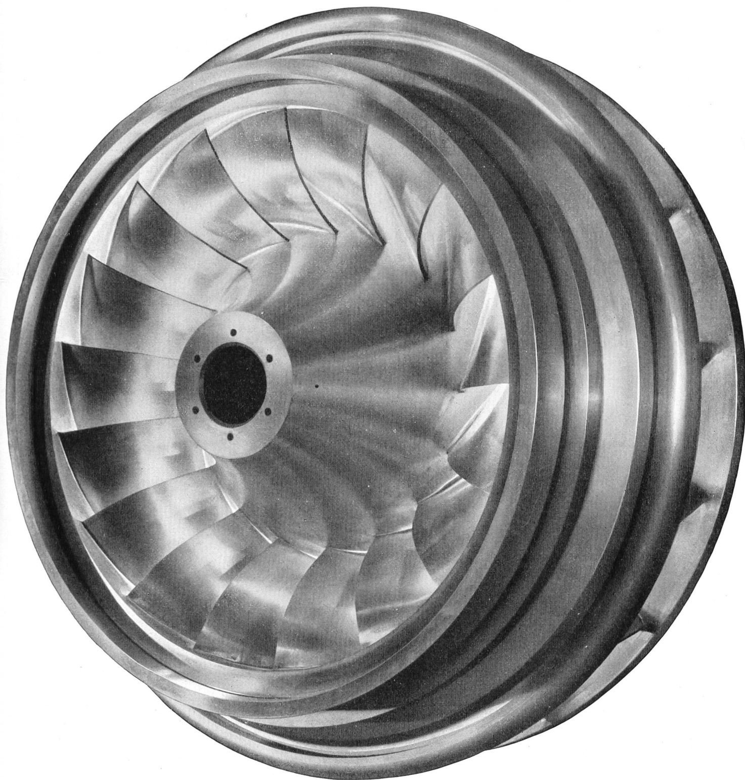
Laufblad für HD-Francis-Turbine der Zentrale Fionnay
