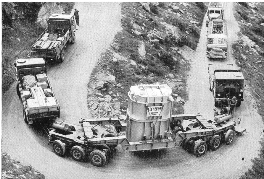
Transport eines 50 t Transformators für das Kraftwerk Fionnay auf steiler, enger und kurvenreicher Straße
