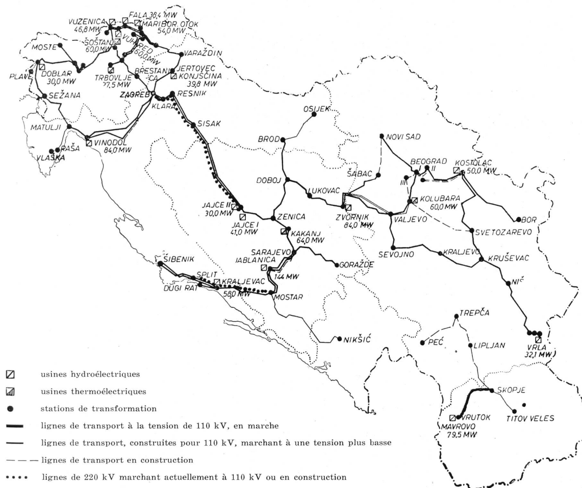
Fig. 98 Les lignes de transport à haute tension en Yougoslavie en 1957 (d'après la revue «Elektroprivreda» No 5—6, 1957).
