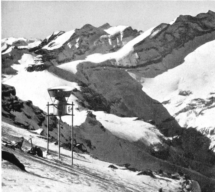
Bild 1 Niederschlagsmeßstation (Totalisator) im oberen Einzugsgebiet der Linth. Blick gegen Süden auf Kistenstöckli und Abschluß des Limmernbodens, dahinter Bergmassiv südlich von Val Frisal.
