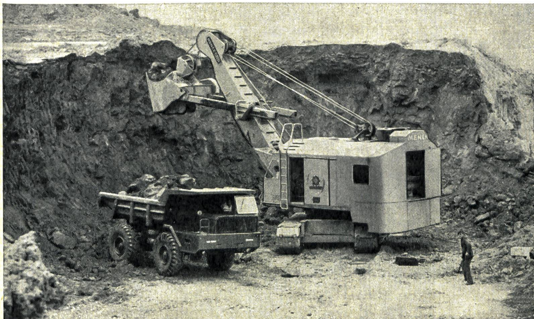
Ein 2,5 m 3 Universalbagger vom Typ MENCK M 251 bei schwerem Einsatz
