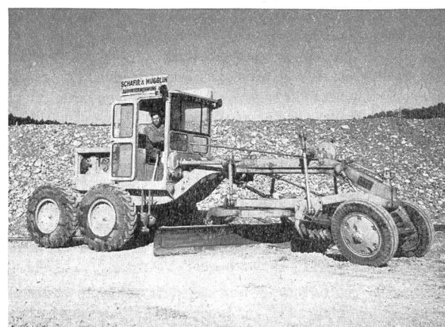
Abb. 14 Motor-Grader Caterpillar Gewicht: 9 t Länge: 7,60 m Breite des Schürftblattes: 3,60 m Motorleistung: 75 PS
