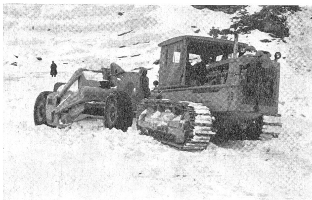
Abb. 12 Schneerräumen auf der Baustelle Göschenenalp. Einsatz eines Scrapers mit Raupentraktor als Zugmaschine.
