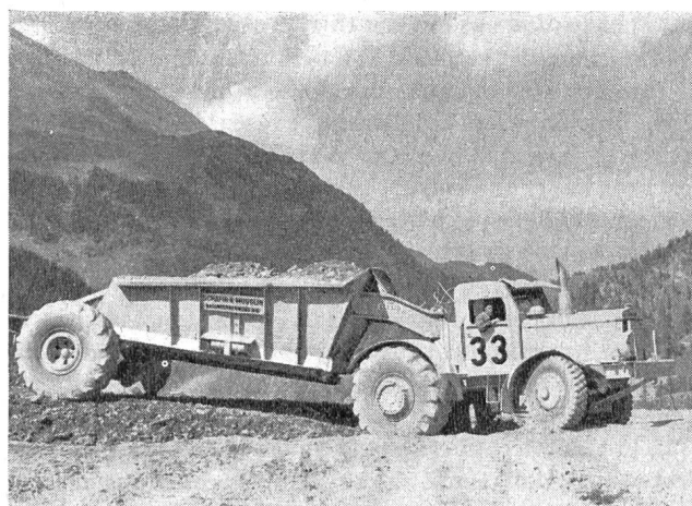
Abb. 11 Euclid-Sattelschlepper Ladefähigkeit: 10—11 m 3 Gewicht beladen: rd. 40 t Motorleistung: 190 PS Spurweite: 3,25 m Länge über alles: rd. 12 m
