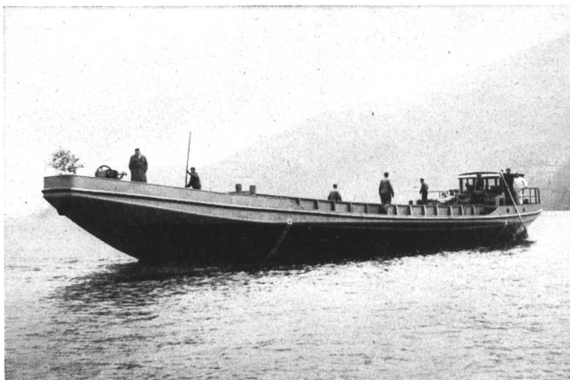
Lastmotorschiff «Büren a/A», Baujahr 1954, Tragkraft 120 t
