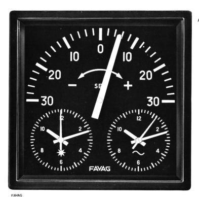
sind wesentliche Teile des elektrischen Uhrennetzes von Kraftwerken und zeigen an:
