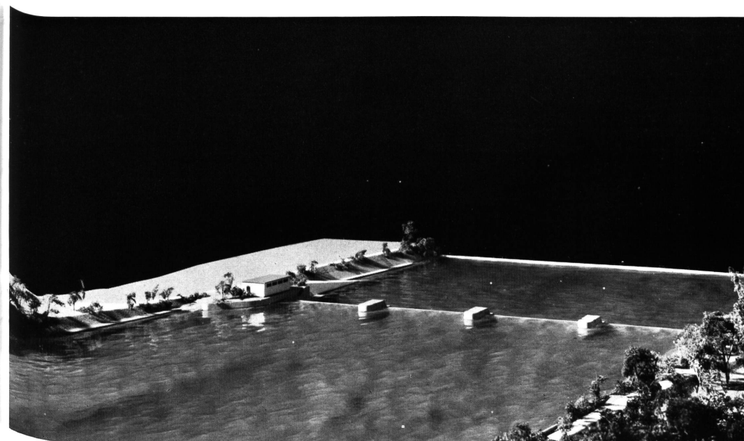
Abb. 13 Oberes Hilfswehr mit Reguliergebäude und Kahrrampe; am rechten Ufer Fischzuchtanstalt Stoll. Modellaufnahme vom Oberwasser
