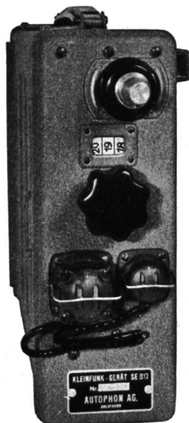
Links: Abb. 2, Gerät von oben. Konus mit Gewinde für die Antenne, Skala mit Drehknopf für die Kanalumschaltung, Schutzkappe auf der Steckdose der Sprechgarnitur, Blindstecker auf Steckdose der Fremdpeisung.
