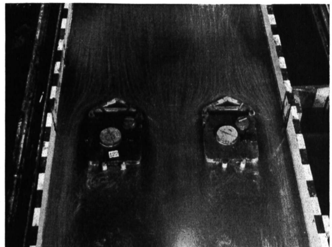
Abb. 11 Glatter Durchfluß bei zusätzlicher Beaufschlagung der Spiralschützen und der ohne Last laufenden Turbinen.
