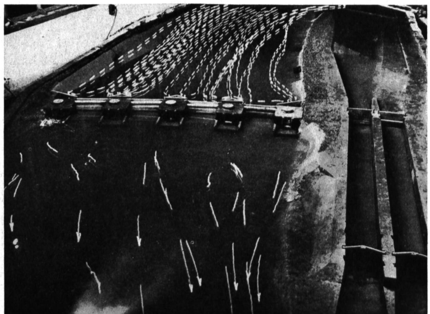
Abb. 16 Ansicht vom Unterwasser. Anströmung des im selben Flußbett aufgebauten Pfeilerkraftwerkes. AQ = 1750 \text{ m}^3/\text{s} .
