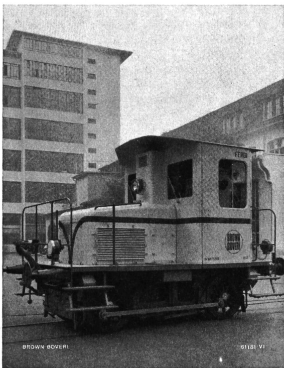
Abb. 2 Dieselelektrische Rangierlokomotive für die Bedienung von privaten Anschlußgleisen und für den Werkrangierverkehr
