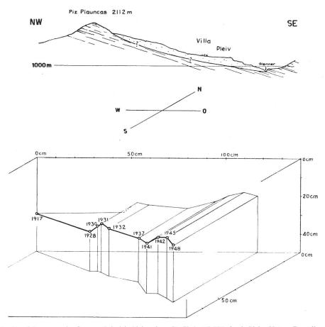
Abb. 3 Terrainbewegung im Lugnez, Beispiel: Pleiv, oben: Profil 1:75 000 durch Pleiv. Unten: Darstellung der Bewegung des Vermessungspunktes Pleiv von 1917 bis 1948 in schiefer Parallelprojektion.
