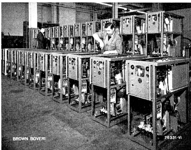
Abb. 3 Serienmontage von 4-kW-Hochfrequenzgeneratoren. Die Fabrikation in größeren Serien ermöglicht in Verbindung mit dem Prinzip der Baukasten-Konstruktion die weitgehende Erfüllung von Spezialwünschen bei gleichzeitig niedrigem Preisniveau.
