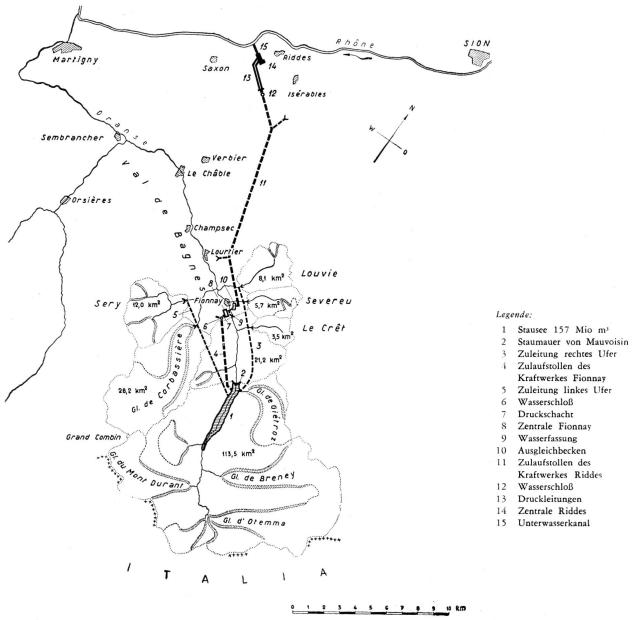
Abb. 1 Übersichtsplan der Kraftwerke Mauvoisin
