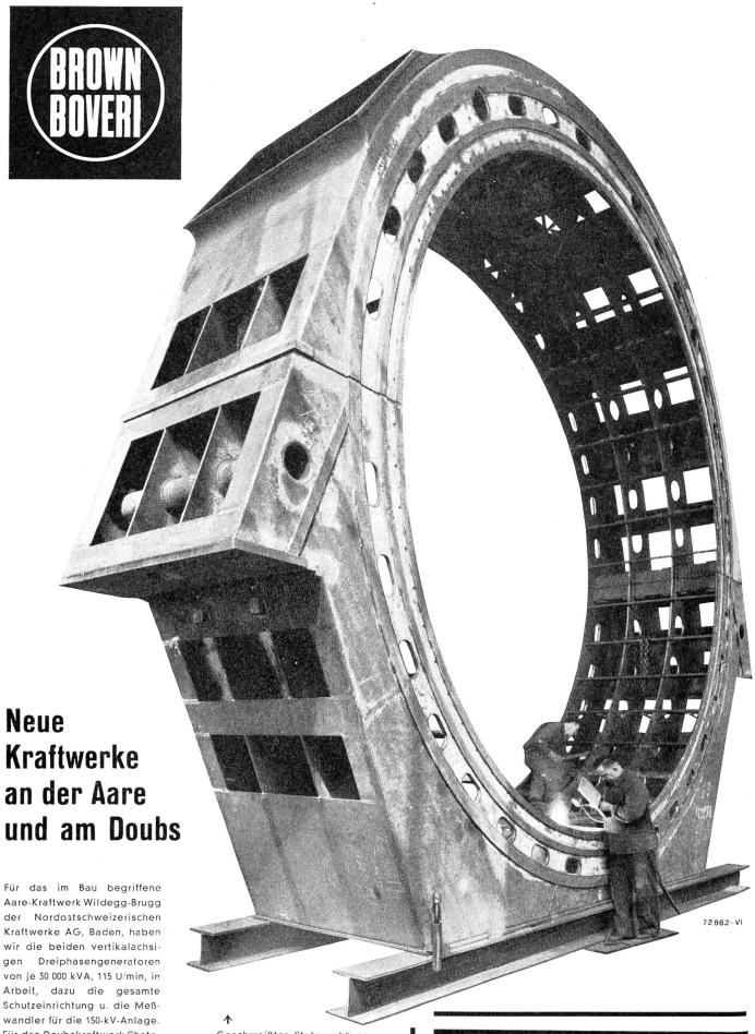
der Nordostschweizerischen Kraftwerke AG, Baden, haben wir die beiden vertikalachsigen Dreiphasengeneratoren von je 30 000 kVA, 115 U/min, in Arbeit, dazu die gesamte Schutzeinrichtung u. die Meßwandler für die 150-kV-Anlage. Für das Doubskraftwerk Chatelôt der Société Forces Motrices du Chatelôt liefern wir die beiden horizontalachsigen Dreiphasengeneratoren von je 20 400 kVA, 500 U/min.
