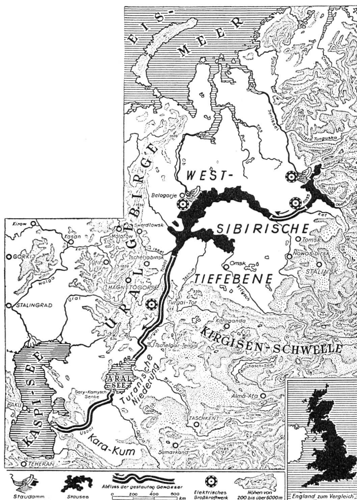
Fig. 5 Plan des ouvrages de retenue pour force motrice, irrigation et réglage des crues dans l'ouest de la Sibérie
