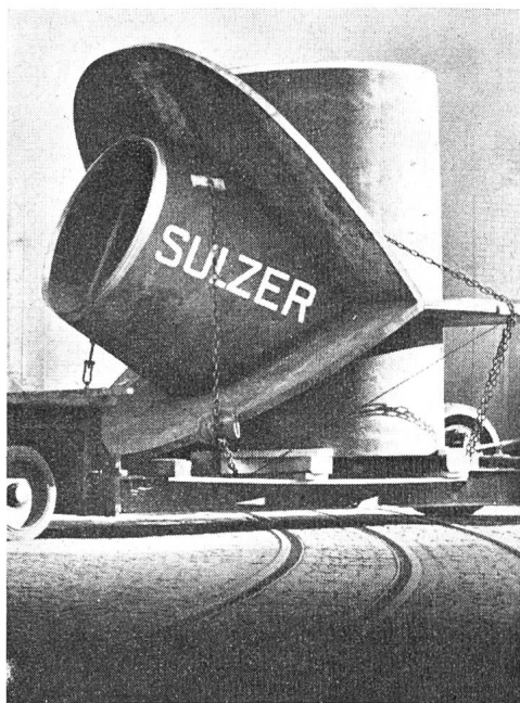
Druckleitungs-Abzweigstück von 14 Tonnen Gewicht, ausgerüstet mit Sulzer-Verstärkungskragen
