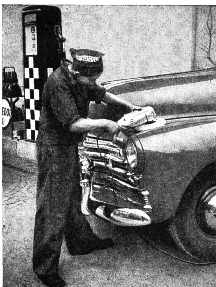
Abb. 8 Hand-Poliermaschine in praktischer Anwendung in der Garage. (Perles.)
