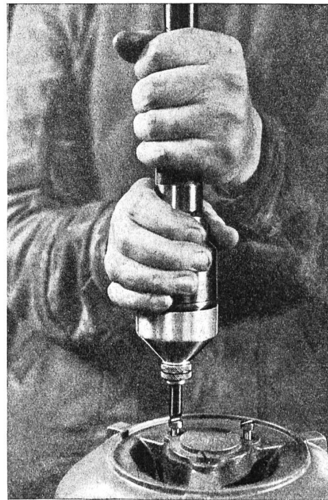
Abb. 13 Elektromotorisch angetriebener Schraubenzieher. Arbeitsablauf: a) Aufsetzen der Klinge auf den Kopf, der in das Loch eingesteckten Schraube. b) Einziehen der Schraube (Bild). Die Hand gleitet vom Einstellring zum Bremsring und bewirkt durch leichtes Bremsen desselben die Drehung der Klinge. c) Durch entsprechend starkes Bremsen (oder einstellbaren Auslöser) kann die Schraube um Bruchteile einer Umdrehung festgezogen werden. (Werkaufnahme O. Suhner AG, Brugg.)
