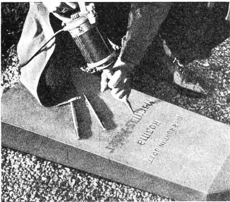
Abb. 11 Eingravieren von Inschriften mit dem Elektrohammer. (Perles.)
