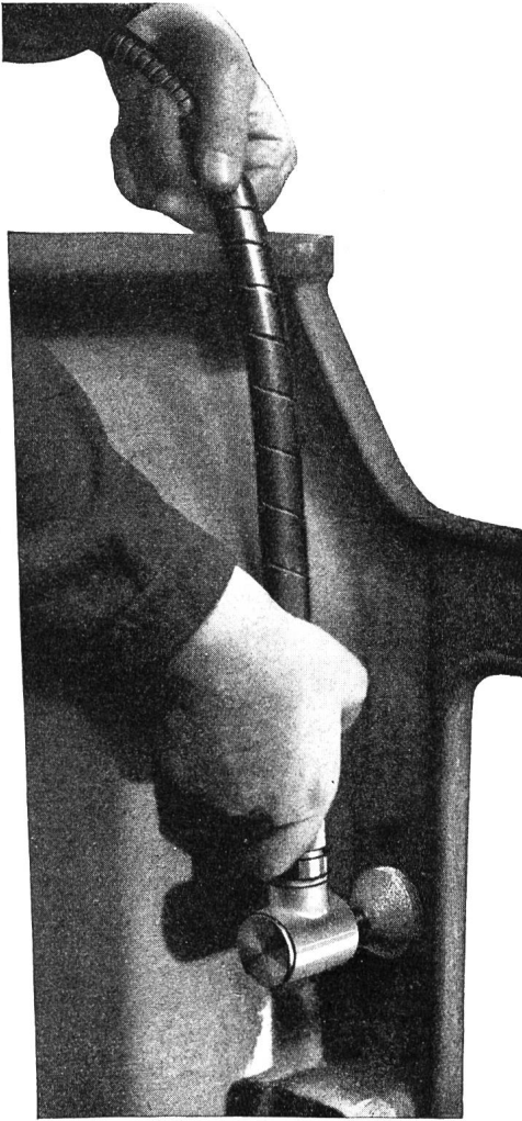
Abb. 16 Schmiergeln schwer zugänglicher Partien mit biegsamer Welle und Winkel-Werkzeughalter. (Suhner.)
