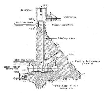
Abb. 6 Staumauer Göschenen, Querschnitt durch die Wasserfassung der Göschenenreuss. Maßstab 1:500.
