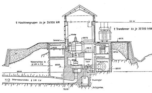
Abb. 15 Querschnitt durch das Maschinenhaus Wassen. Maßstab 1:500.
